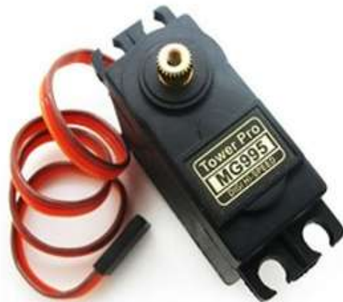
Fig. 3. Servo Motor (MG995).
